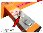
Posizionare il JIG con il lato rosso nella direzione dell'installazione. Regolare la livella per il lato rosso. Girare il JIG di 180° e posizionarlo con il lato giallo nella direzione dell'installazione. Regolare la livella per il lato giallo.
