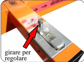
Posizionare il JIG con il lato rosso in direzione dell'installazione. Regolare la livella per il lato rosso.
