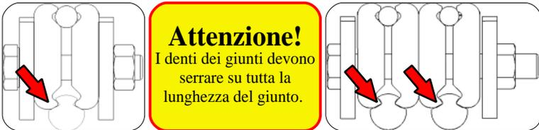
Serrare le viti dei giunti con 50 Nm utilizzando una chiave dinamometrica e ri-serrare 3 volte.
