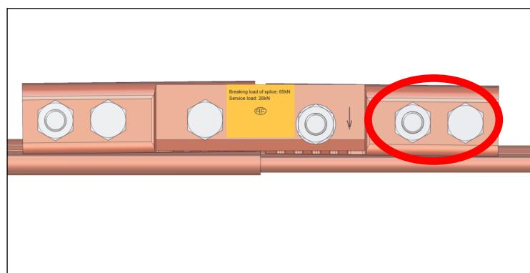
5. Régler la hauteur de la griffe striée, de sorte que la face inférieure des deux fils de contact soit au même niveau.
