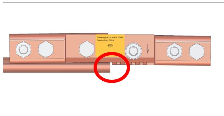
Serrer les boulons extérieures à **50 Nm**.
