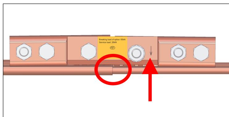
Serrer les boulons extérieures à **50 Nm**.
