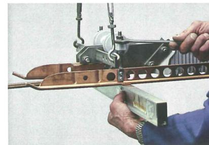
12. Contrôler le glissement optimal au moyen d'un niveau ou d'un pantographe.
