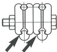
7. Scier ou couper le fil de contact de chaque côté dans les dégagements des deux serre-fils.
