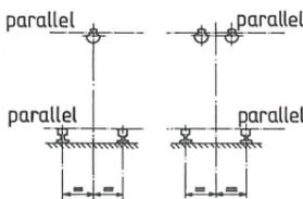
2. Poser le fil de contact et le câble porteur au centre des rails  $\pm 50$  mm. Les fils de contact et le câble porteur doivent se trouver l'un au-dessus de l'autre avec une déviation maximale de
