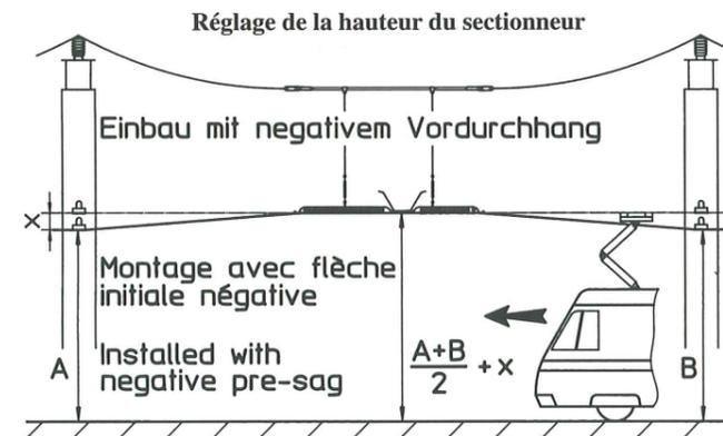
Ensuite faire le réglage fin. Aligner le parallélisme du corps du sectionneur par rapport aux rails à l'aide du niveau à bulle d'air. Monter provisoirement les fils de sûreté des tendeurs.
