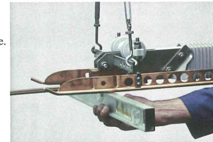
13. Avec deux clés, serrer les écrous des patins et fixer les avec les contre-écrous.
