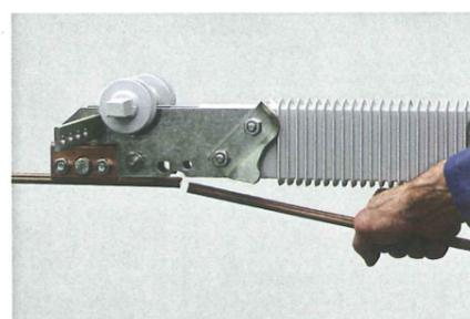
9. Resserrer encore une fois les vis des serre-fils à 50 Nm et serrer les contre-écrous.
