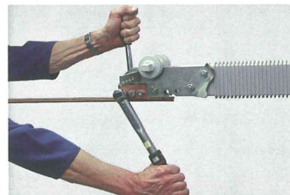
10. Plier les extrémités du fil de contact vers le haut avec le marteau. Supprimer d'éventuels coudes de la ligne de contact au moyen du gabarit en bois et du marteau.
