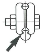
**ATTENTION!** Les dents des serre-fils doivent être en prise sur toute la longueur dans les encoches du fil de contact! Sinon: DANGER DE GLISSEMENT!
