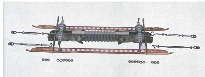
6. Monter le sectionneur sans les patins sur le fil de contact. Serrer les vis des serre-fils à 50 Nm et les resserrer 3 fois afin que les rainures pénètrent dans le fil de contact.
