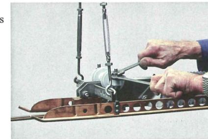
14. Important ! Resserrer encore une fois toutes les vis, bloquer les tendeurs avec les contre-écrous et attacher les extrémités des câbles de suspension.
