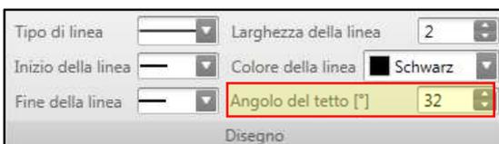
Lo strumento di pianificazione RED CAD Flury registra gli elementi importanti per l'installazione. Per registrare correttamente le lunghezze dei dispositivi di captazione è necessario impostare l'angolo del tetto in caso di tetti a falda.
