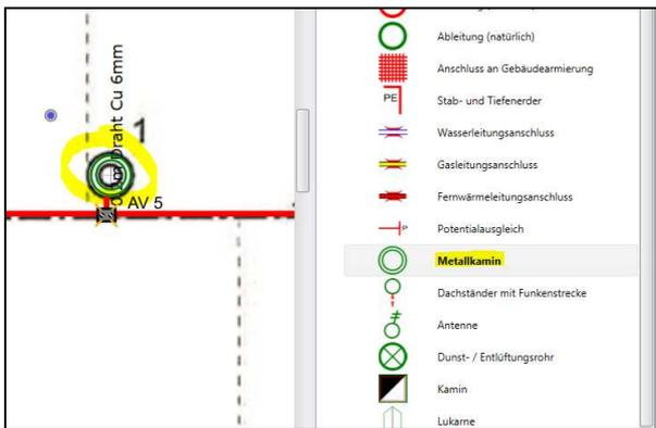
In unserem Musterplan wird das Symbol „Metallkamin“ mit der linken Maustaste angeklickt. Mit dem Pfeil der Maus auf den Plan gehen. Pfeil ändert sich zu einem Kreuz. Mit dem Kreuz auf die Einfügestelle gehen und einmal mit der linken Maustaste klicken. Das Symbol ist eingefügt.
