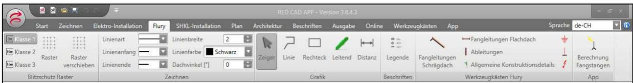
Unter dem Register „Flury“ sind alle relevanten Bedienteile und Symbole für die Blitzschutzplanung.
