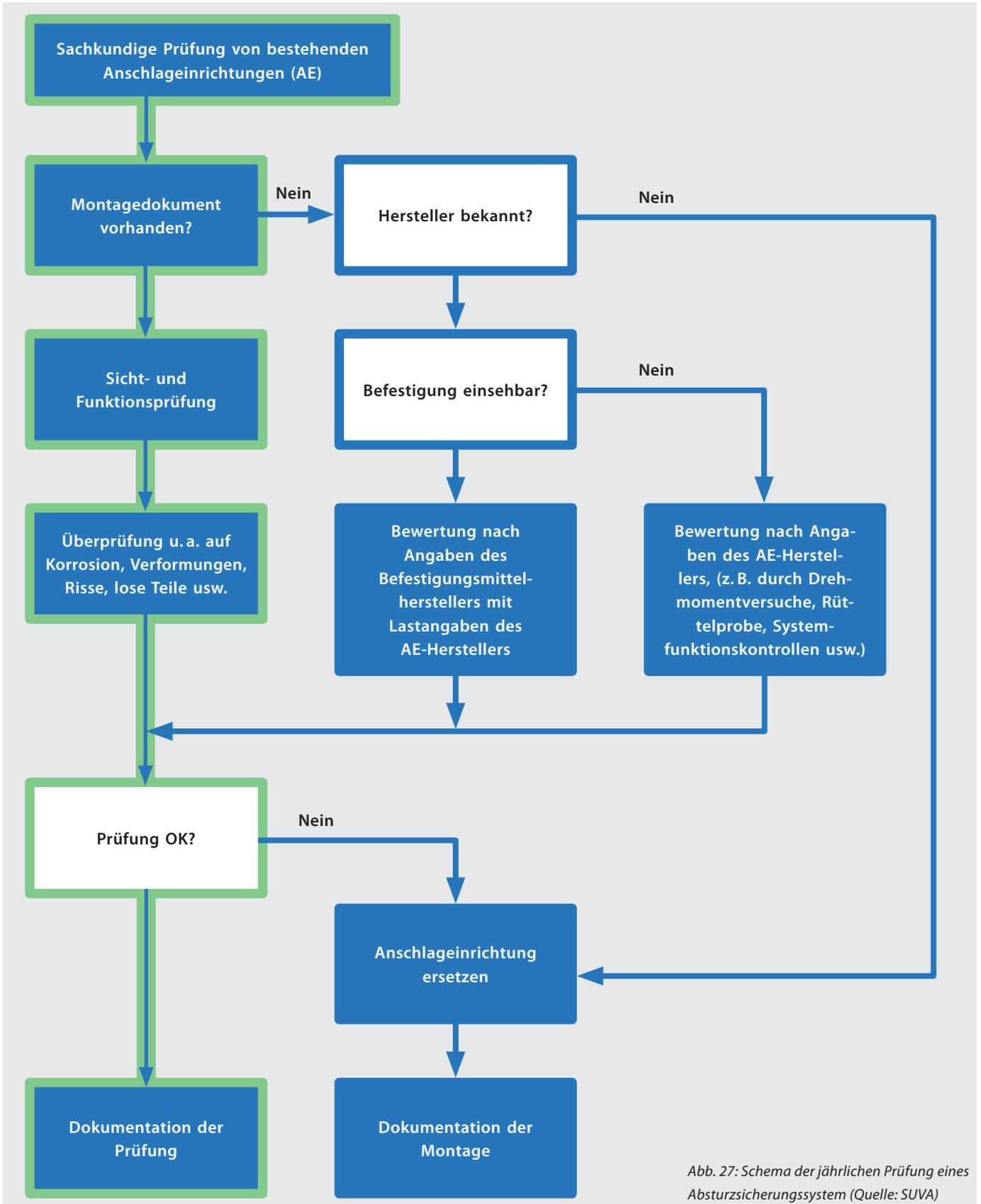
Abb. 27: Schema der jährlichen Prüfung eines Absturzsicherungssystem (Quelle: SUVA)
