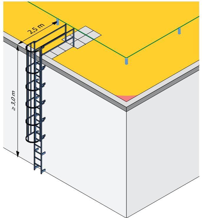
Abb. 20: Zugang über eine fix montierte Leiter
