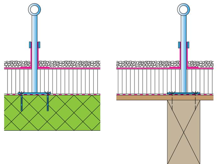
Abb. 3: Ausstattungs-klasse 1: EAP auf einem wärme-gedämmten Flachdach eingebaut, Variante auf einer Beton- und einer Holzunterkonstruktion
