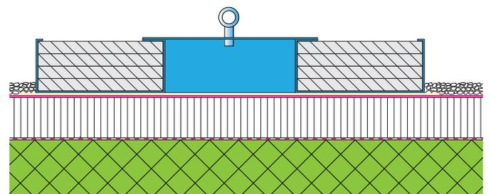
Abb. 4: Ausstattungs-klasse 1: Anschlagpunkte mit Auflast ohne Durchdringungen der Abdichtung. Diese Punkte können temporär eingesetzt werden, dürfen jedoch bei frostigen Temperaturen für Arbeiten, wie z. B. Schneeräumen, nicht verwendet werden.
