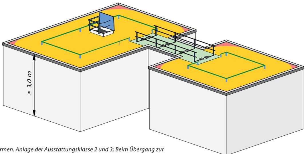
Abb. 14: Beispiel spezielle Dachformen. Anlage der Ausstattungsklasse 2 und 3; Beim Übergang zur anderen Dachfläche kann das Seil der Ausstattungsklasse 2 nicht mit einem Abstand von 2,5 m erstellt werden, daher für diesen Bereich auf die Ausstattungsklasse 3 mit Seitenschutz wechseln.
