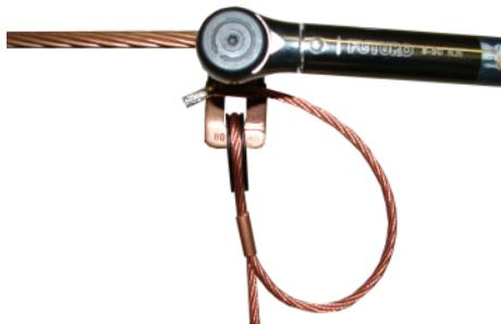
2. Befestigen der Seilhängerklemme am Fahrdraht. Anziehen der Schraube mit 25 Nm.
