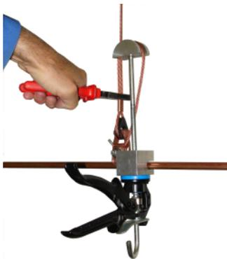
8. Verpressen der Presshülse mit dem Presseinsatz (Typ DB 10 K).
