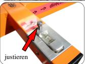
Platzieren Sie das JIG mit der roten Seite in eine von Ihnen beliebig festgelegte Installationsrichtung. Nivellieren Sie die Wasserwaage für die rote Seite.
