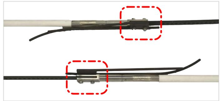
c) Einstellung der verstellbaren Stossklemme. Dafür zuerst die Abnutzung des Fahrdrachts messen. Anschliessend Exzenterachsen regulieren.
